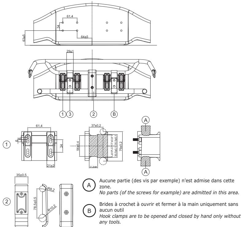
Il n'est permis de fixer le carénage avant sur le kart qu'au moyen du kit de montage de carénage avant. Aucun autre dispositif n'est autorisé. Le carénage avant doit pouvoir reculer librement en direction du châssis sans aucune obstruction d'une partie quelconque pouvant limiter le mouvement.
